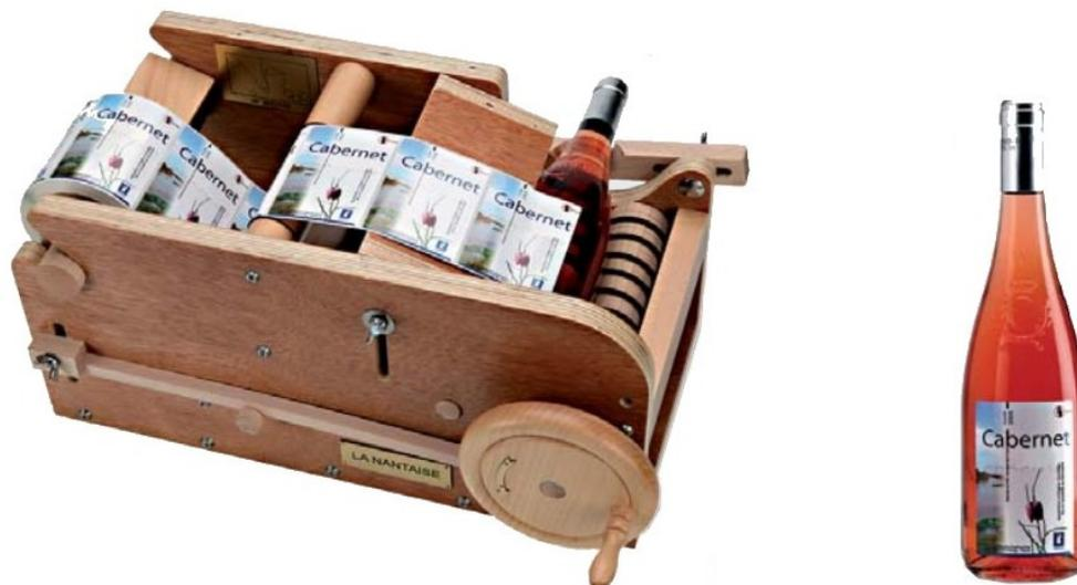
Cet applicateur d'étiquettes représente la solution d'étiquetage manuelle parfaite de vos petites séries sur bouteilles, bidons, bocaux, tubes et tous autres récipients cylindriques et coniques.
