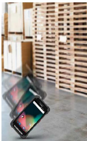
Ainsi, la coque en plastique résistante offre une bonne prise en main et intègre un scanner professionnel. L'écran tactile cinq pouces est pratiquement incassable et extrêmement résistant aux rayures. L'indice IP67 signifie que l'appareil bénéficie d'une protection contre la pénétration de la poussière et de l'eau, ce qui le rend particulièrement adapté pour une utilisation en extérieur par tous les temps. Il fonctionne parfaitement à des températures comprises entre -20 et +50 °C.
