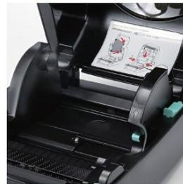
Le support de rouleau d'étiquettes sans tige permet de charger facilement les étiquettes et assure une alimentation fluide en étiquettes
