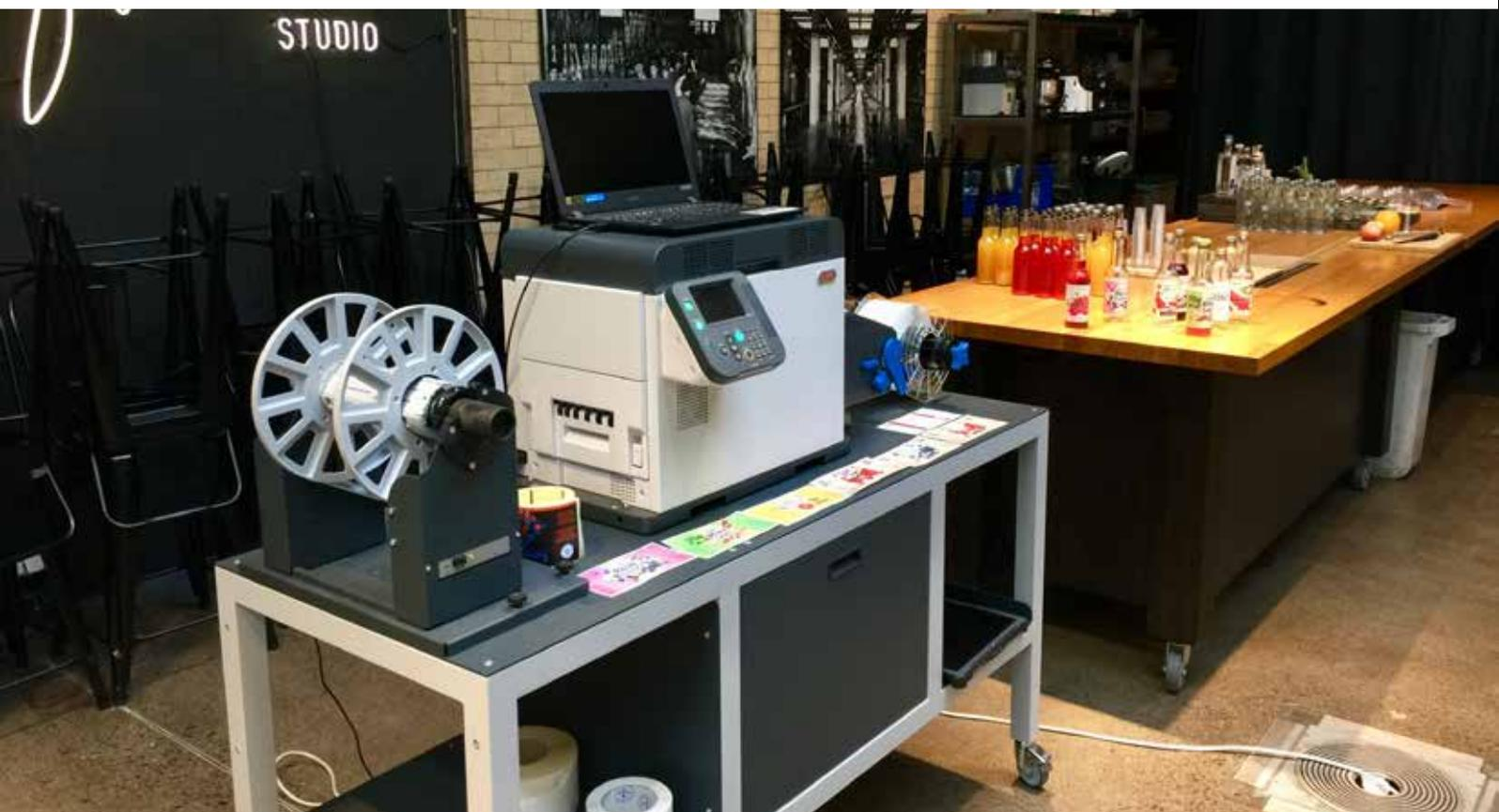
Imprimante d'étiquettes Pro1050 OKI, avec exemples d'étiquettes prêts à être utilisés
